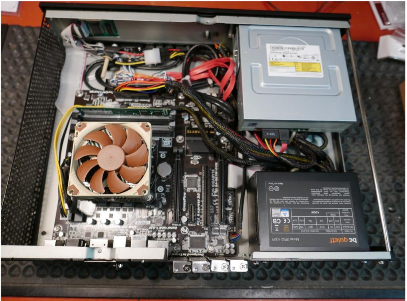
Ich habe die Verbindung vom Parallelport des Mainboards mit einem Flachbandkabel gemacht, was ich passend Pin für Pin mit den dazugehörigen Steckern angefertigt habe. Sieht sauber aus und das Kabel kann unterhalb des Mainboards langlaufen.
